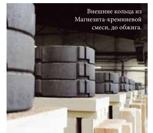
Модель ESKA51/51/51 с тепло-накопительными кольцами Hoxter
